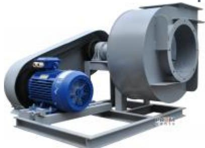
Пылевые вентиляторы среднего давления ВЦП 7-40 применяются в системах вентиляции общего назначения, а также в различных производственных и технологических системах:
